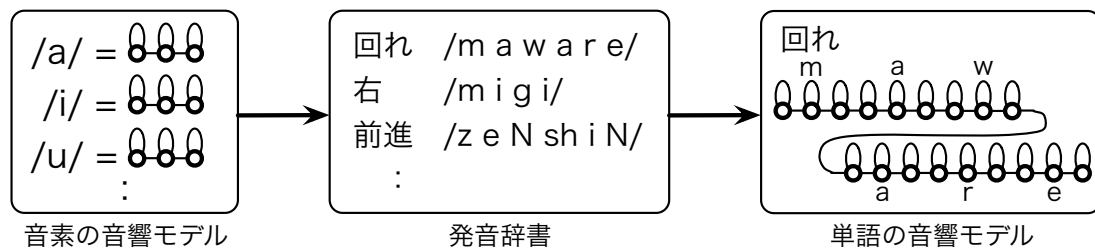
図 12: 発音辞書（音素の音響モデルを用いた単語の音響モデル構成法）
